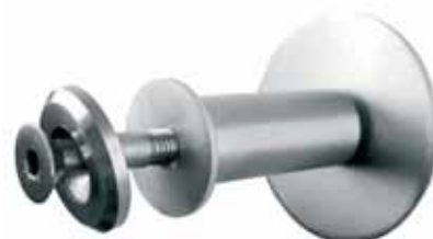
Handlaufträger für Flachhandlauf bis 40 mm Wandabstand 75 mm Wandrosette Ø 60 mm mit Stockschraube und Dübel Art. 6.01.8140
