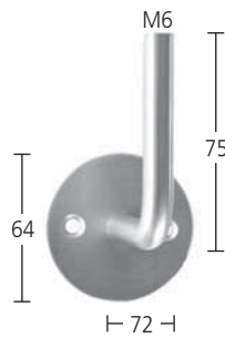
Handlaufträger Stift 12 mm, Loch gesenkt mit Innengewinde M6 Art. 6.01.0070
