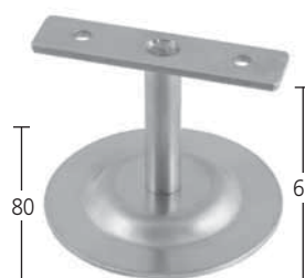
Handlaufträger für Flachhandlauf bis 40 mm Wandabstand 75 mm Wandrosette Ø 60 mm mit Stockschraube und Dübel Art. 6.01.8140
