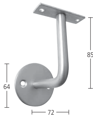
Handlaufträger Stift 12 mm, Loch gesenkt mit gerader Platte Art. 6.01.0090
