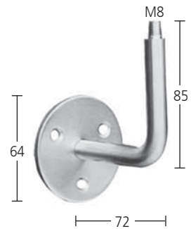
Handlaufträger Stift 12 mm, Loch gesenkt mit Gewinde M8 Art. 6.01.0030
